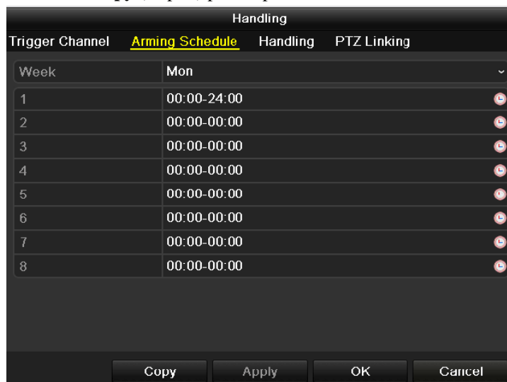
Figura 8. 6 Definir el horario de entrada de alarma
