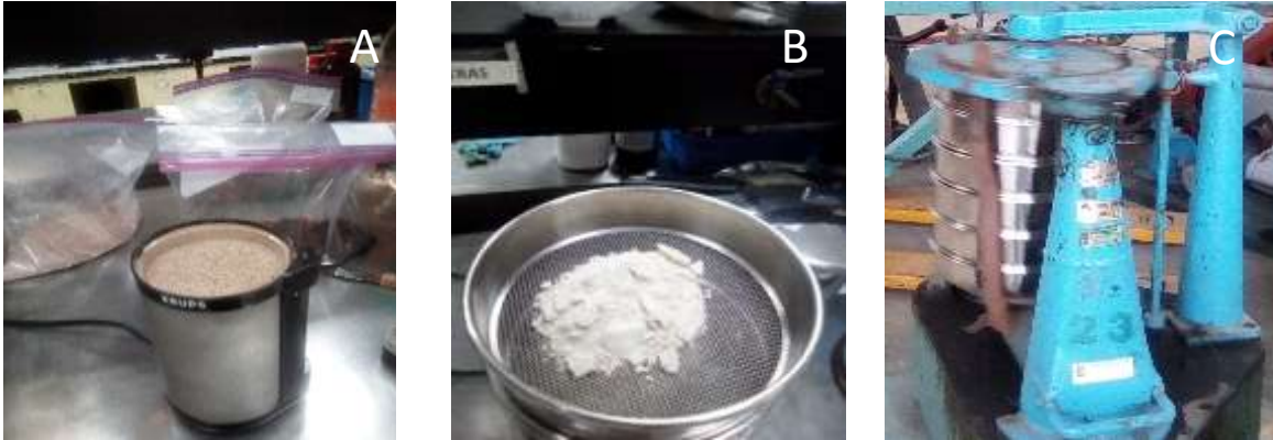
Figura 9. (A, B y C) muestra molida y tamizada.
